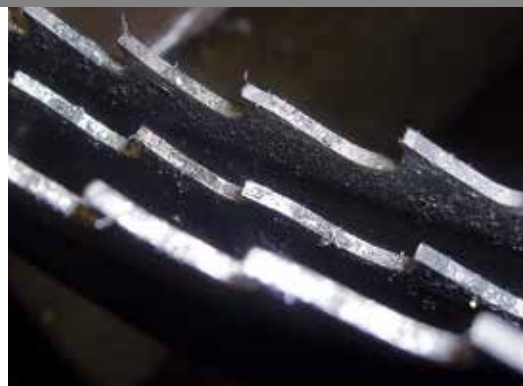
Aderenza trucioli sulla base del dente
