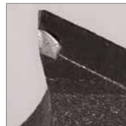
Dente con danni, nessun rodaggio
